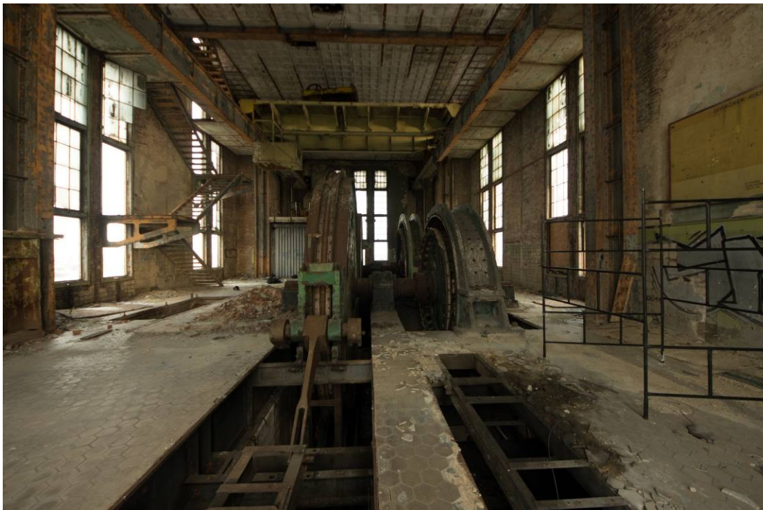
Fot. 20,21 Strop poz. +40,56 Koła maszyny wyciągowej, widoczna suwnica oraz belka podsuwnicowa.
