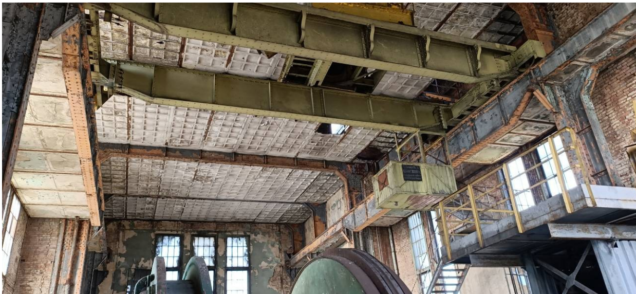
Fot. 29 Suwnica 30T. Strop w poziomie +52,35m.
